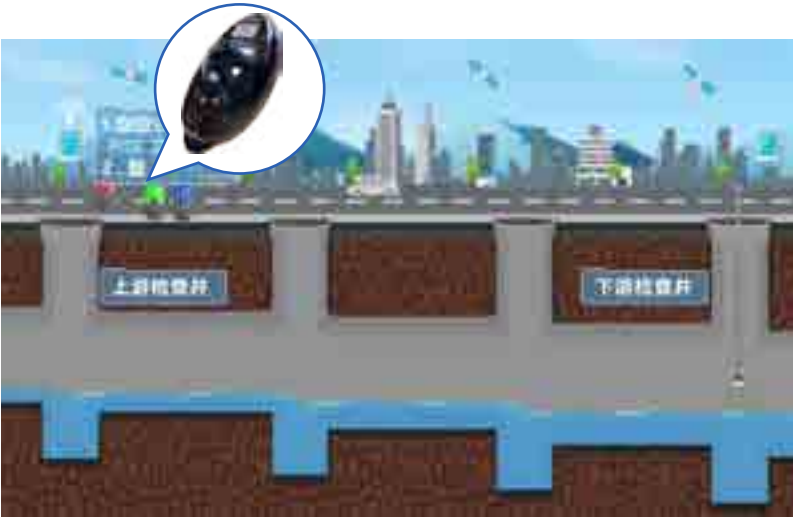
▲李清泉团队研制的管道检测胶囊作业示意图
