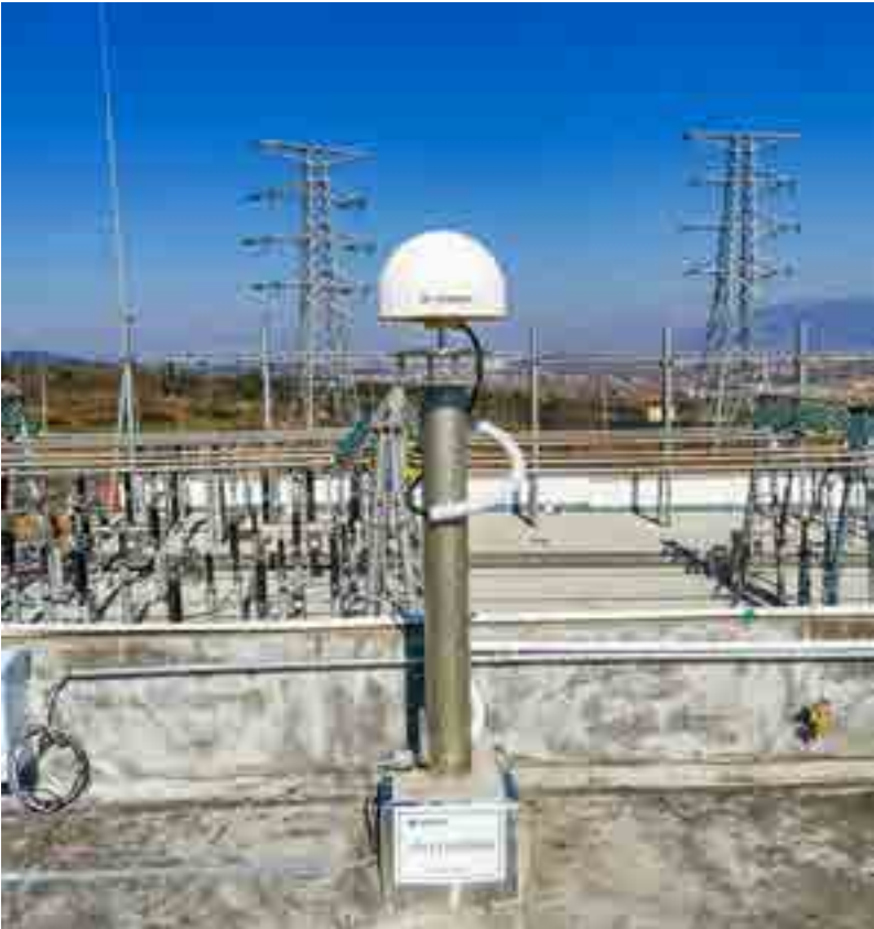
▲南方电网建设北斗基准增强系统，用于无人机自主巡线和地质灾害监测
