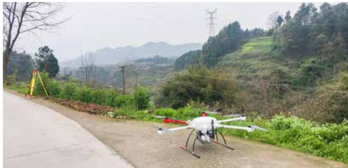
▲安徽宇天使用海达数云ARS-1000L机载激光测量系统开展电力巡检项目
