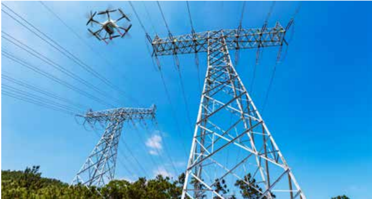
▲海达数云智喙 PM-1500 机载激光测量系统开展电力巡检工作
