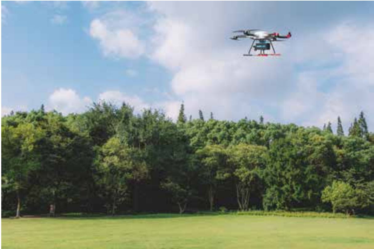
▲海达数云智喙 PM-1500 机载激光测量系统用于林业资源调查
