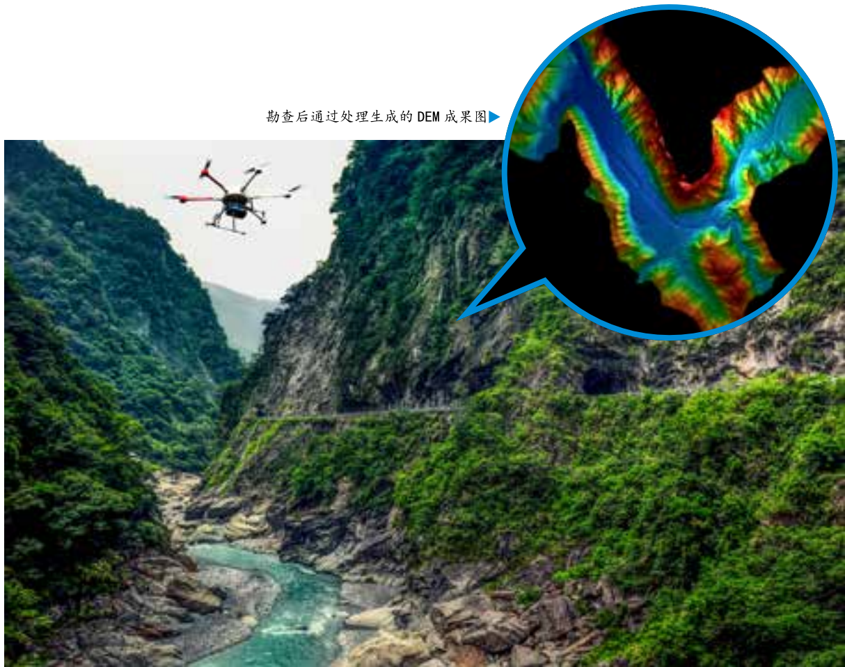
▲海达数云智喙 PM-1500 机载激光测量系统在地质灾害易发区域展开隐患勘查
