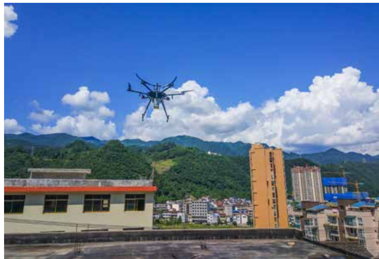
▲海达数云 ARS-200 轻型机载激光测量系统在某县城开展地质灾害勘查
