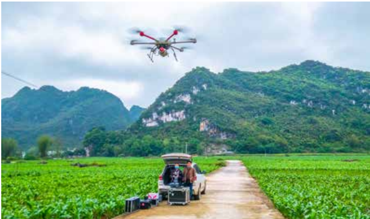
▲海达数云 ARS-200 机载激光测量系统在巴马—凭祥高速公路进行勘测
