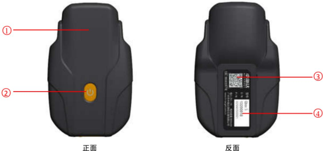
正反面：①主板天线 ②一体式电源键和指示灯 ③二维码，扫描下载配套 APP 软件
