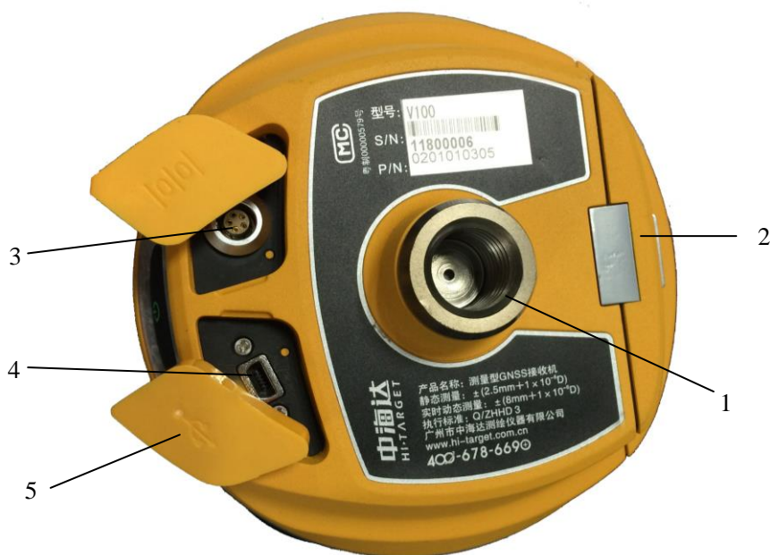
1-连接螺孔 2-电池仓 3-小五芯接口 4-Mini USB 接口 5-防护塞
