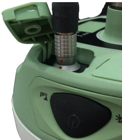
图 4-2 线缆插接示意图
