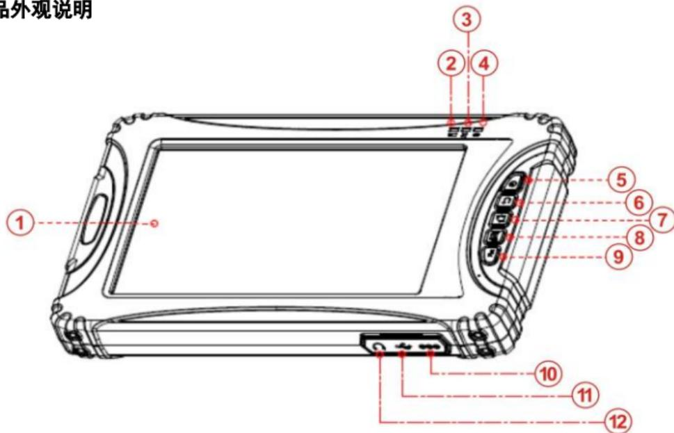
正面：①触摸屏 ②电池指示灯 ③卫星信号指示灯 ④网络信号指示灯 ⑤电源键 ⑥返回键 ⑦主菜单键
