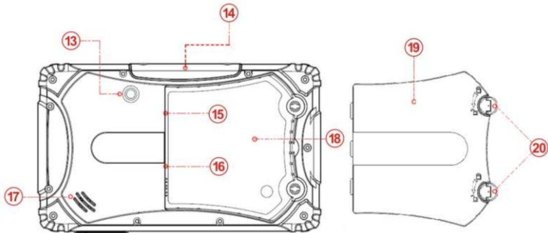
反面：⑬摄像头 ⑭扩展模块接口 ⑮SIM 卡槽 ⑯MicroSD 卡槽 ⑰喇叭 ⑱电池仓 ⑲电池 ⑳电池锁扣
